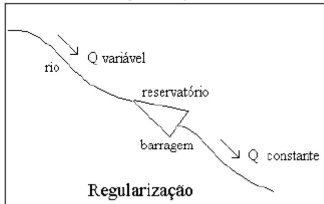
Figura 1 – Reservação para regularização de vazão em um curso d'água natural. Hidrologia Aplicada – CIV 226 Regularização de vazão Prof. Antenor R. Barbosa Jr.
